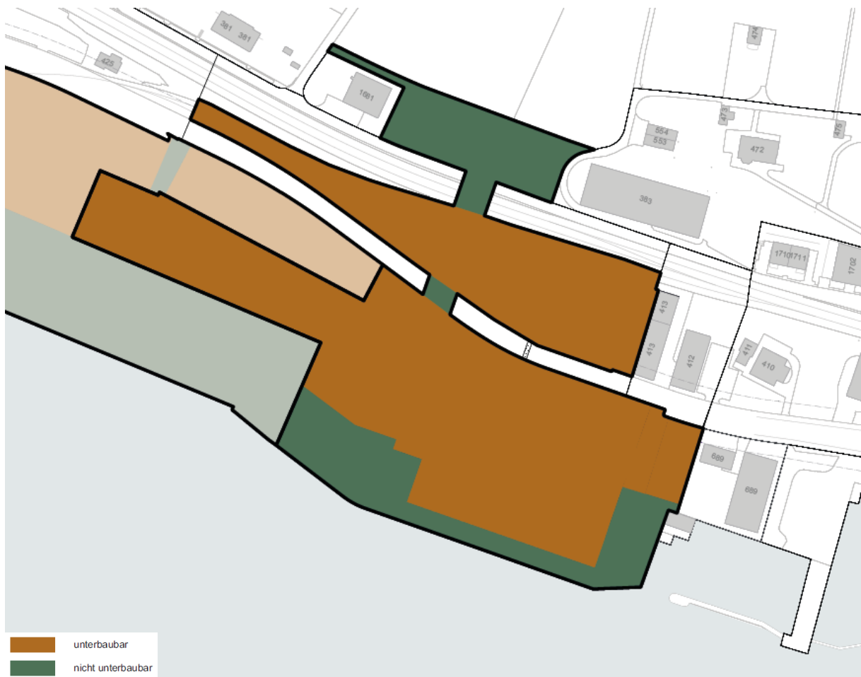
Abb. 16: Unterbaubare Bereiche; EBP, 2020
